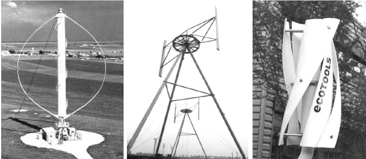
Figure 1-13 Exemples des constructions VAWT a) Darrieus, b) Darrieus de type H, c) Savonius
