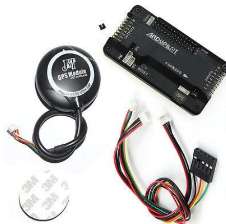
Figure I-13 : Un GPS 6M avec un contrôleur d vol APM 2.8 pour drone
