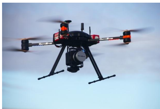
Figure I-15 : Technologie LIDAR OnyxScan embarquée sur drone - AltiGator Drone & UAV Technologies.
