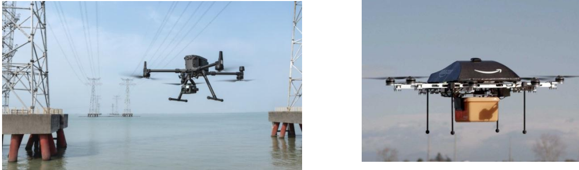
Figure I-19 : applications des drones (a) Matrice 300 RTK et ses caméras hybrides multicapteurs Zenmuse H20 (b) livraison Amazon.
