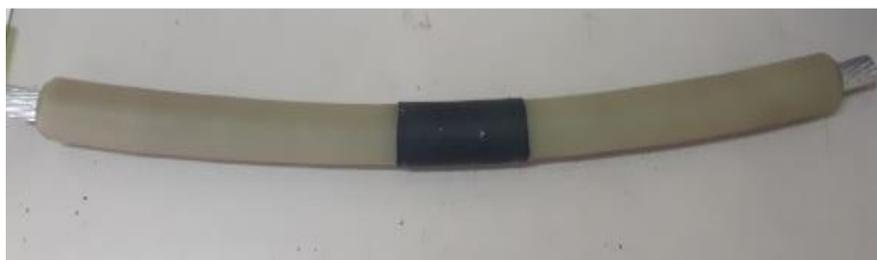
**Figure II.10** Extrémités d'un tronçon de câble préparé pour les mesures de décharges partielles,
