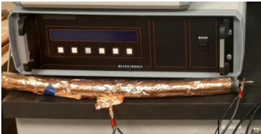
**Figure II.3** Câble préparé pour la spectroscopie diélectrique (BDS).
