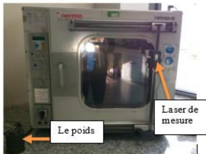
**Figure II.13** Etuve utilisée pour essai d'allongement a chaud
