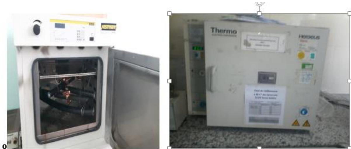
Figure II.25 Etuve pour vieillissement thermique
