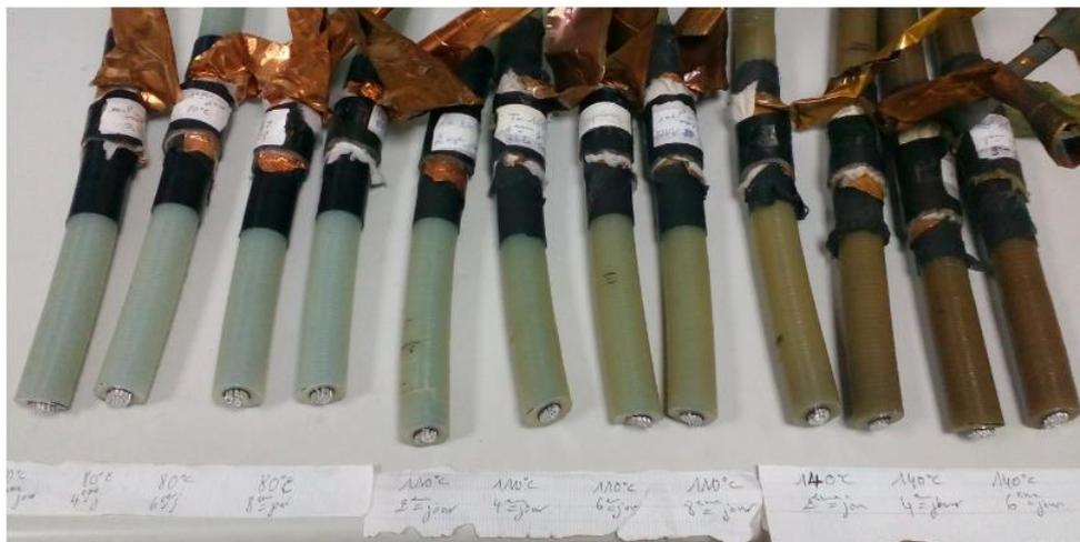
**Figure III. 4** Changement de couleur du PRC sur des câbles MT (18/30) kV au cours du vieillissement pour différentes températures de vieillissement.
