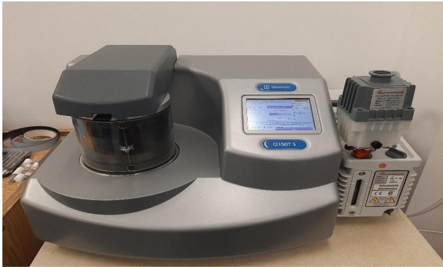
**Figure II.22** Machine à pulvérisation pour métallisation des échantillons.
