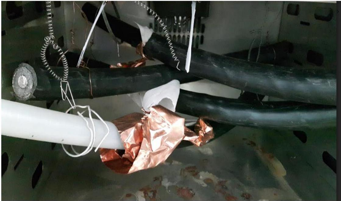
**Figure II. 26** Les tronçons de câbles complets et extrudés au cours de vieillissement thermique.
