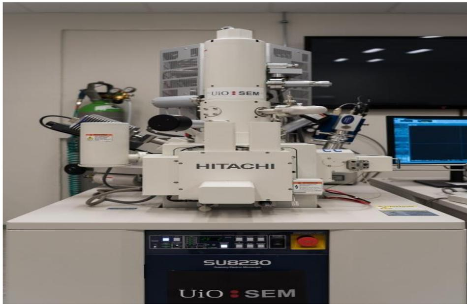
Figure II.19 Microscope électronique à balayages SU8230.
