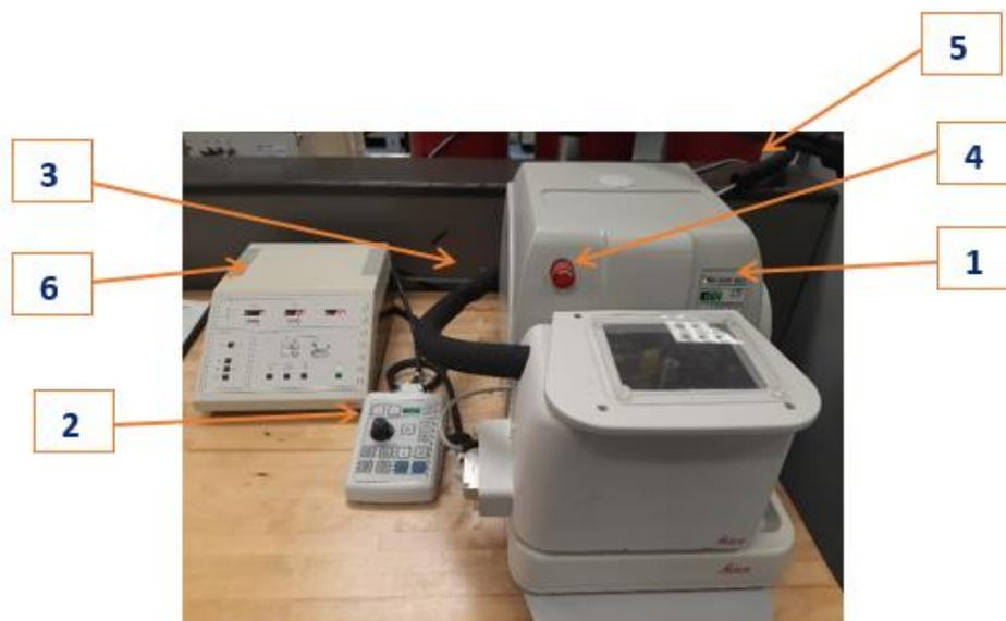
Figure II. 20 MICROTOME LEICA RM226.
