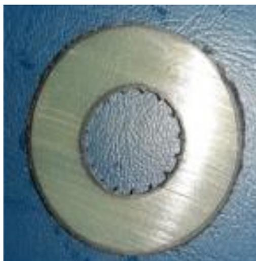
**Figure II. 3** Echantillons coupés de câble préparé pour la caractérisation physico-chimique.
