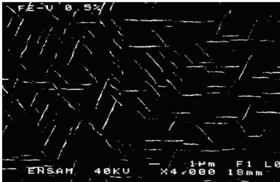
Fig. V.5 : Micrographie au M.E.B du binaire Fe-V à 0,5 % V attaqué au Nital 3%.
