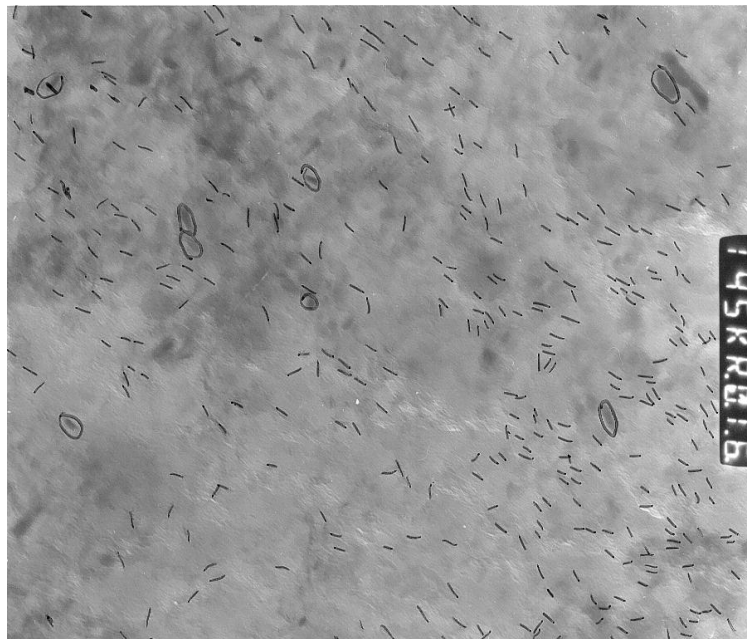
Fig. V. 50 Micrographie au M.E.T, obtenue à partir d'une réplique sur lame mince à une profondeur de 100 \mu\text{m} , de la zone de diffusion de l'acier 32CrMoV13, qui montre la substitution des carbures de revenu par les nitrures de chrome CrN.
