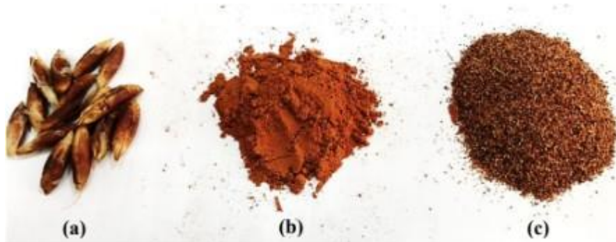
FIG. 2.2 : Types de renfort utilisés : (a) ND (b) FND 300 \mu m (c) poudre FND 500 \mu m
