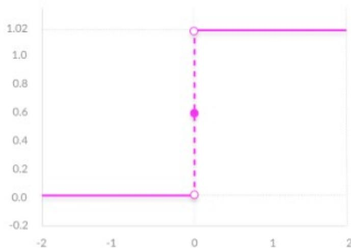
FIGURE 2.13 – Graphe de fonction d'activation à seuil
