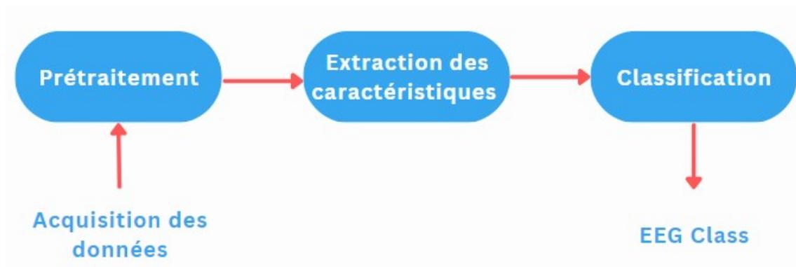
FIGURE 1.11 – Architecture du système de traitement et classification des signaux EEG
