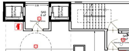
FIG. 1.11 – Disposition des escaliers et ascenseurs au niveau terrasse
