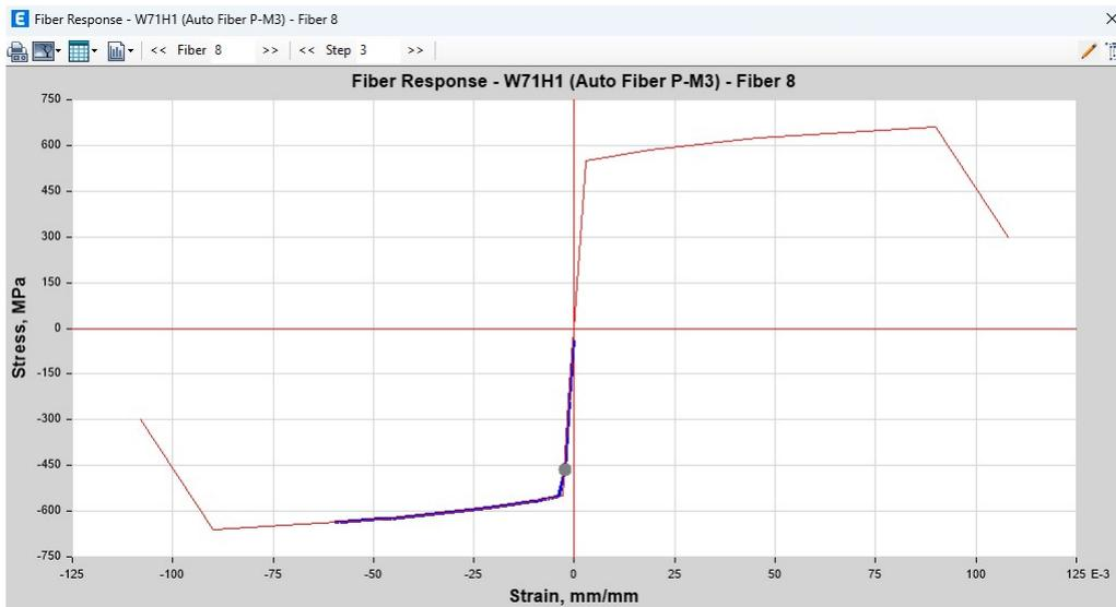
FIG. 5.26 : Comportement du fibre d'acier de la rotules 71
