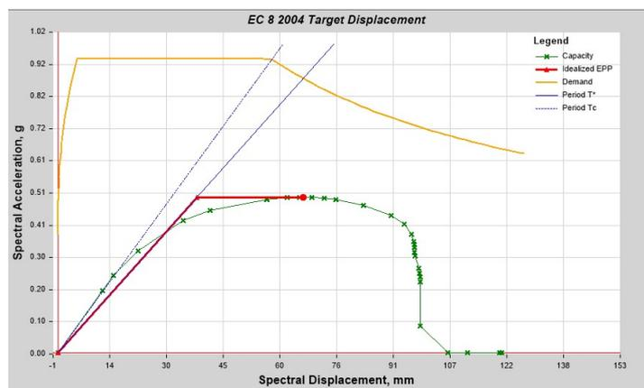
FIG. 4.22 : Courbe de capacité suivant X par rapport à l'action sismique
