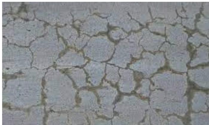
FIG. 1.1 : L'effet de la réaction alcali-granulaire sur le béton
