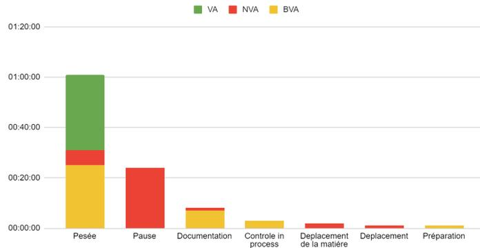
FIG. 3.13 : Histogramme de répartition des tâches pour l'opération 1 de pesée
