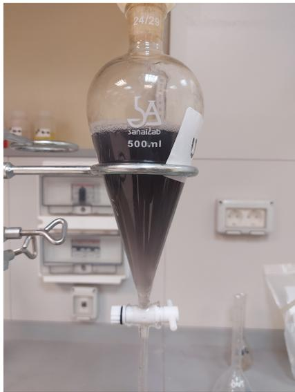
(a) Echantillon après ajout du coagulant à 100 ppm et 15°C
