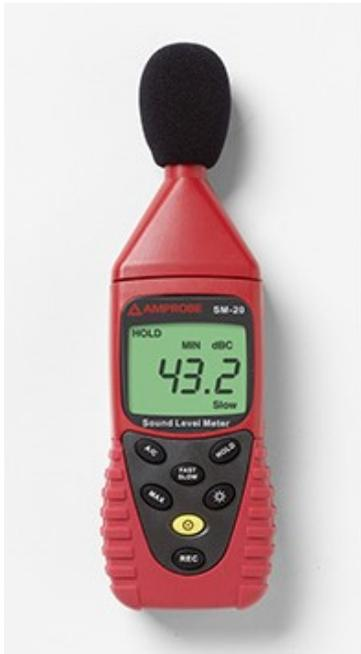
Ce sonomètre a été conçu pour répondre aux exigences de mesure des ingénieurs travaillant dans les domaines de la sécurité, de la santé, des agences de sécurité industrielle et du contrôle qualité dans différents environnements. Il est conforme aux normes CEI651 type 2, ANSI S1.4 type 2 et JISC1502 pour les sonomètres.
