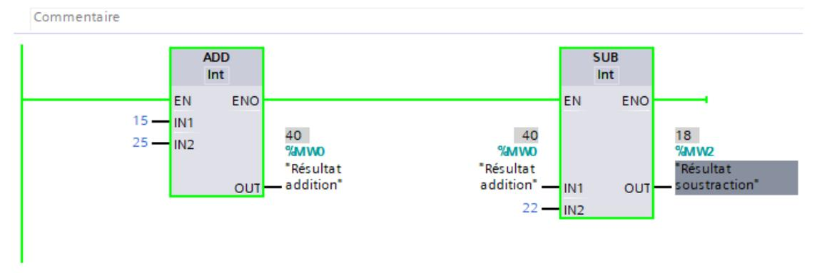
FIGURE 2.4 – Exemple d'addition et soustraction sur le TIA Portal
