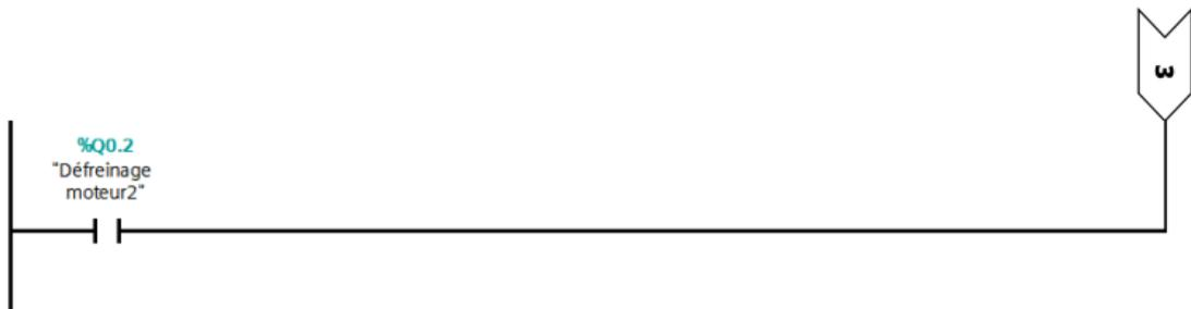
FIGURE 3.18 – Contact de maintien
