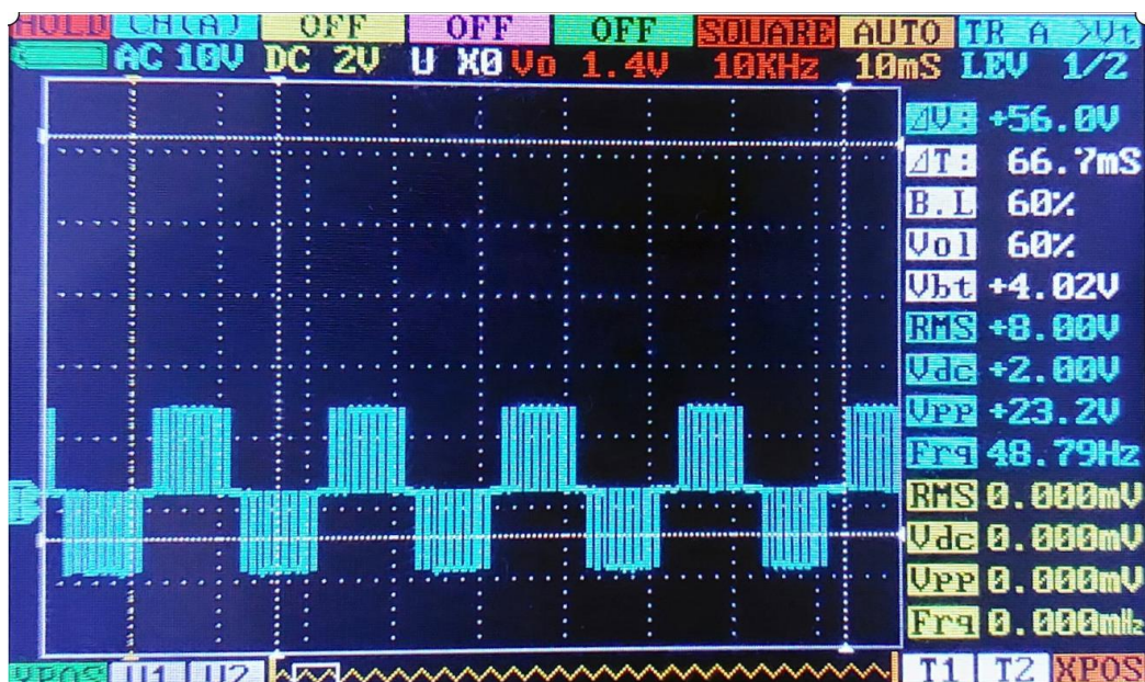
Figure V-27 : L'allure de la tension à la sortie de l'onduleur avant le filtre
