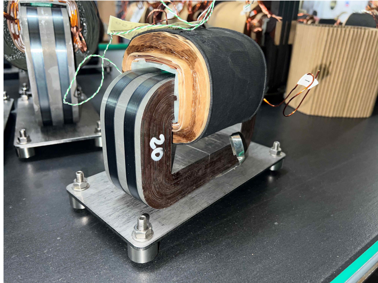
FIGURE 3.13 – Circuit magnétique du transformateur
