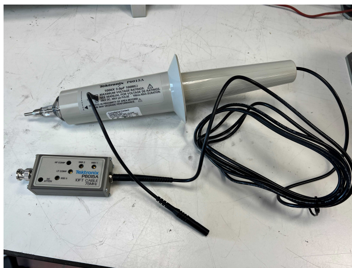
FIGURE 4.4 – Sonde TEKTRONIX P6015A
