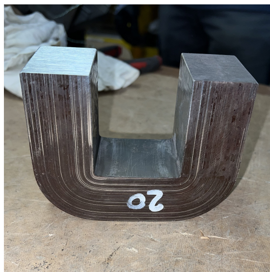
FIGURE 3.7 – Demi-noyau avant l'assemblage.
