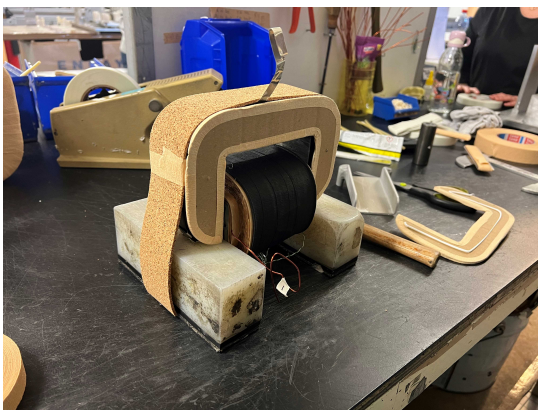
FIGURE 3.14 – Transformateur avec une couche de liège "le gansage"
