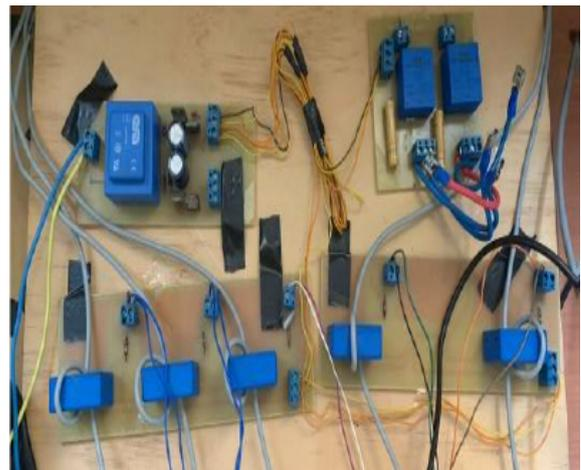
FIG. 2.31 : Codeur incrémental (gauche), Circuit de mesure des courants (droite).
