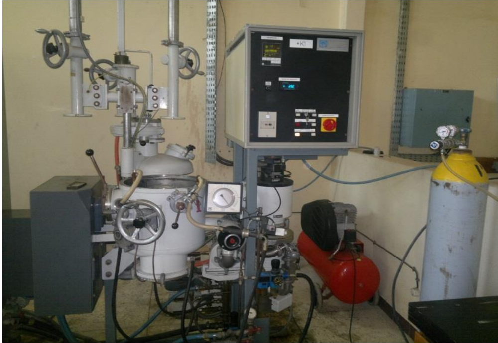
Figure 2.1: Four à induction de moyennes fréquences
