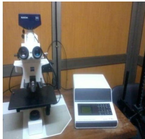
Figure 2.11: Mesure de la micro-dureté Vickers :
