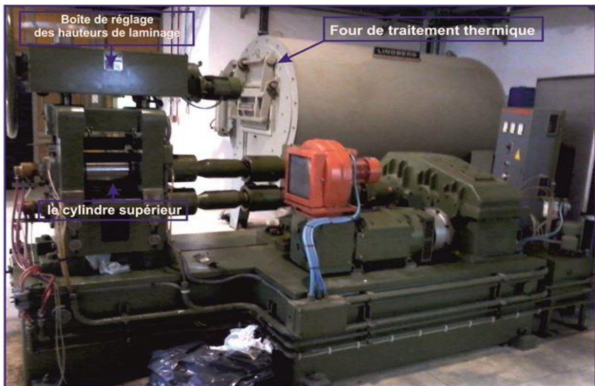
Figure 2.3: Laminoir industriel utilisé pour tous les opérations de laminage
