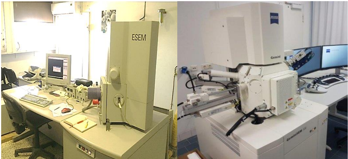
Figure 2.5: Microscopes électroniques à balayages utilisés: a) Philips XL30 FEG ESEM, b) ZEISS Gemini SEM 300
