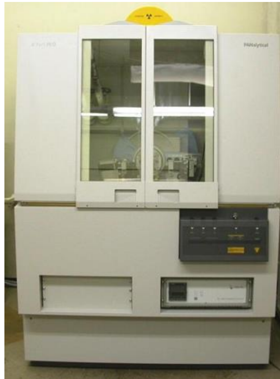
Figure 2.6: Diffractomètre à poudre PHILIPS X'PERT PRO MPD
