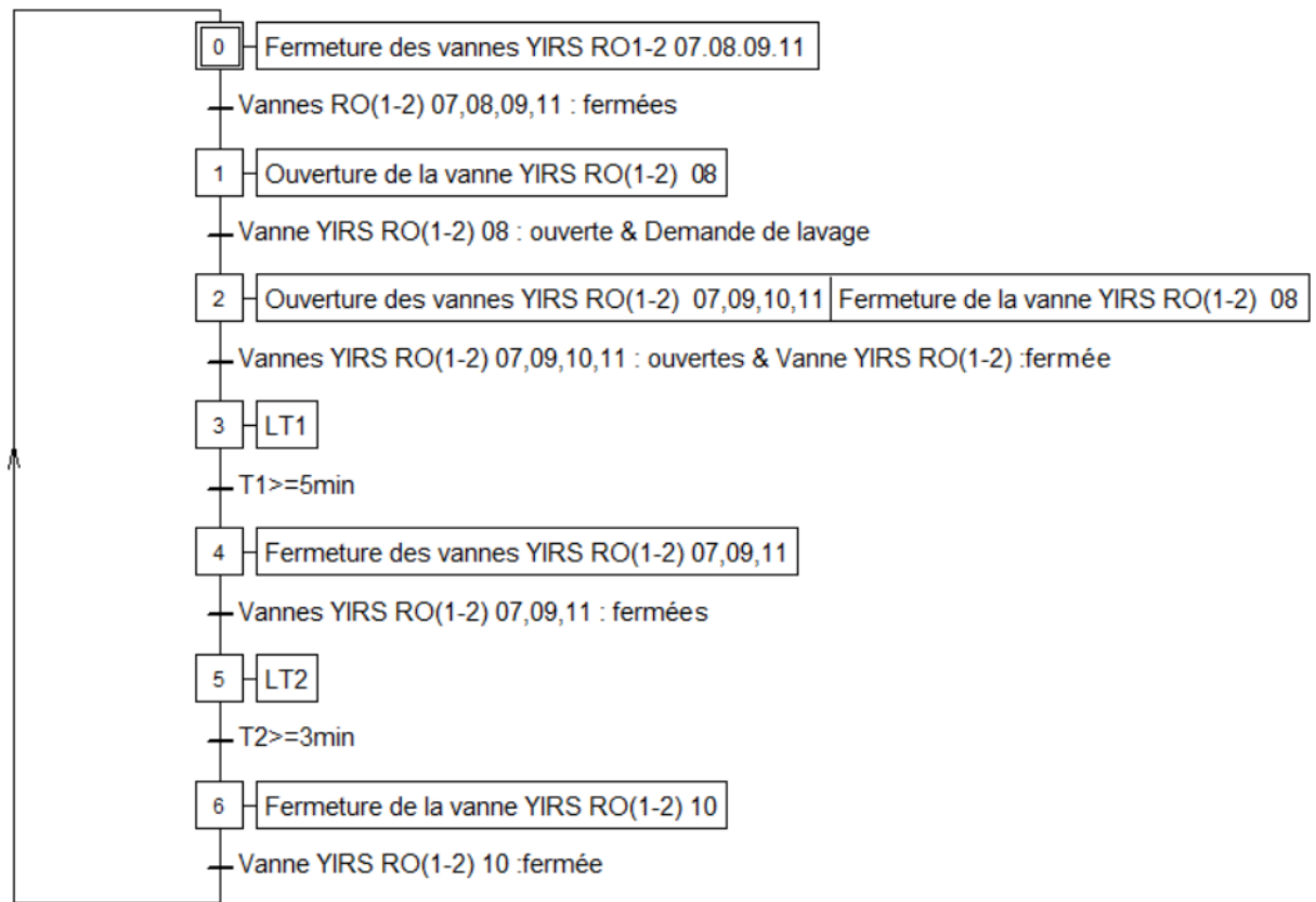
FIGURE 3.10 – GRAFCET de la séquence de fonctionnement des sous processus des racks d'osmose inverse
