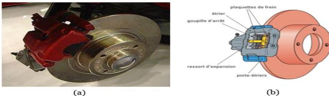
Figure 4-1 : (a) Frein à disque ; (b) schéma d'un frein à disque
