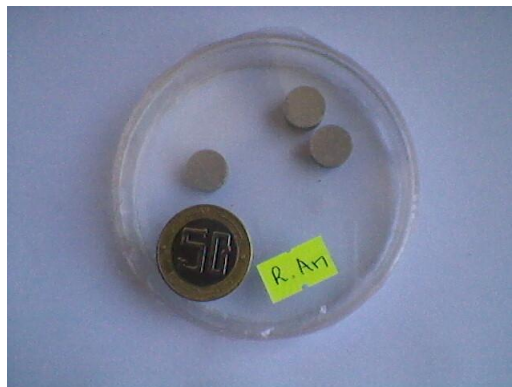
Figure 2.10 : Pastilles préparées pour les analyses par MEB- EDX. Nous avons réalisé 30 pastilles.
