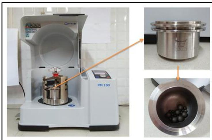
Figure 4.7 : Vue intérieur et extérieur du broyeur planétaire Retsch PM 100
