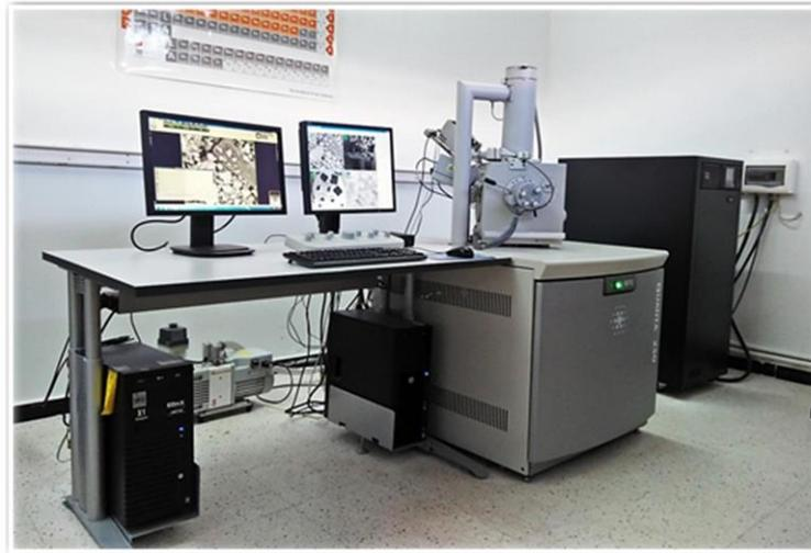
Figure 4.20 : Microscope électronique à balayage QUANTA 250.
