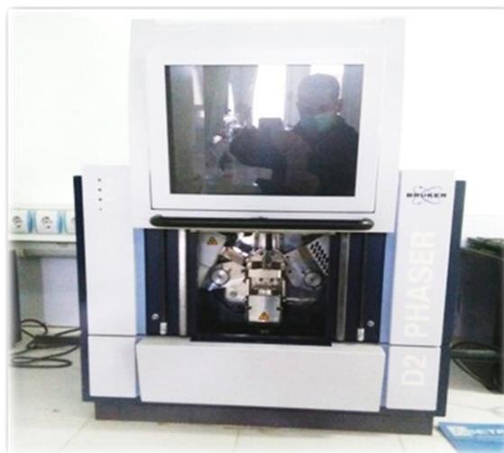
Figure 4.26 : DRX de type D2 PHASER, marque BRUKER
