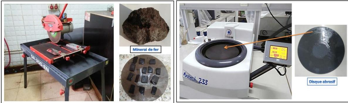
Figure 4.16 : à gauche ; scie avec lame diamantée, Polisseuse Conforme au Décret 92 767 du Juillet 1992 ; à droite ; minerai de fer découpé. PRESI – TR VERNOLLES ;
