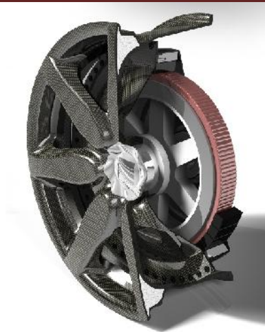
Fig. 1.8 Vue d'un Moteur Synchrones à aimants intégré dans une roue de Véhicule électrique
