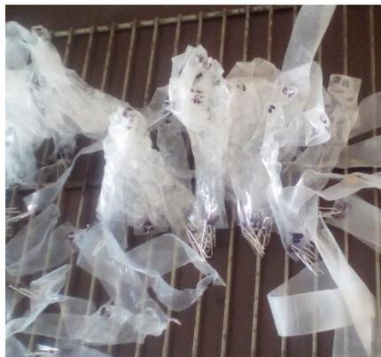
Figure V.15. Photo des échantillons soumis à un vieillissement artificiel accéléré : Etat du PEBD blanc après 35 jours d'exposition
