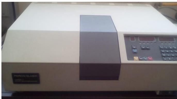
Figure III.31. Spectromètre U.V-Visible. Laboratoire de spectroscopie-moléculaire, département CSE/ IAP de Boumerdès.
