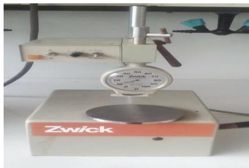
Figure III.13. Photo d'un duromètre.
