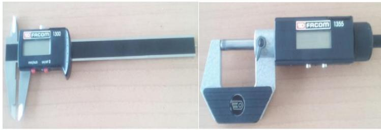
Figure III.9. Le pied à coulisse et Le micromètre.
