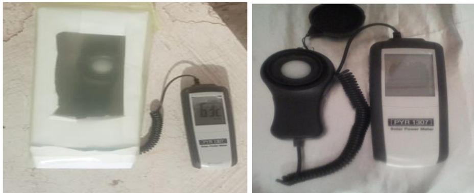
Figure III.34. Photo d'un pyranomètre.
