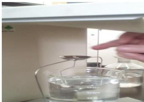
Figure III.25. Mesure de poids d'extrudât non immergé.
