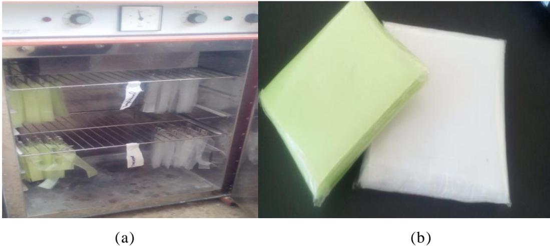
Figure V.2. Photo des échantillons soumis à un vieillissement artificiel accéléré dans une étuve ventilée. Laboratoire Polymère IAP-Ecole de Boumerdes.
