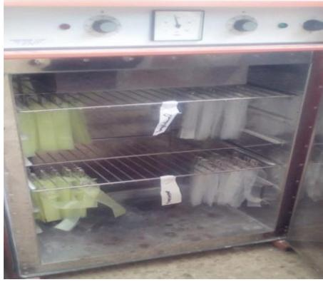
Figure III.16. Installation des échantillons dans l'étuve.
