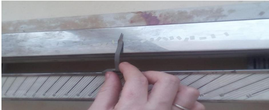
Figure III.29. Lecture de température de fusion.
