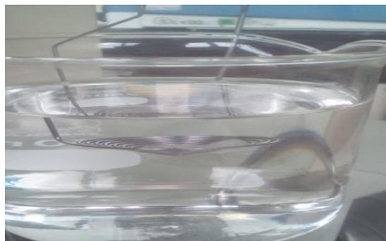
Figure III.26. Mesure du poids de l'extrudat immergé.
