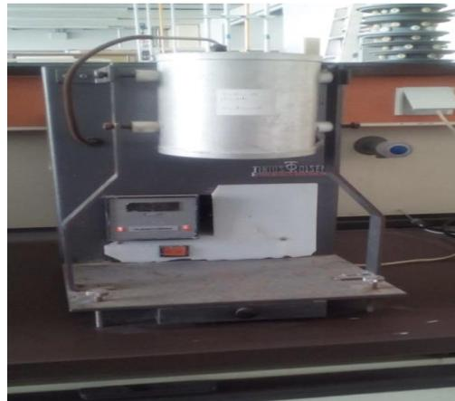
Figure III.17. Appareillage de mesure de l'Indice de Fluidité (Melt Flow Index MFI)
