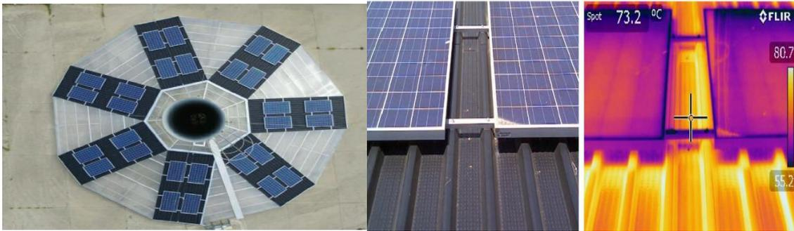
Figure. II.24. CCS expérimentale hybridation du collecteur avec système photovoltaïque. Unité expérimentale à Trakya, Université, Edirne, Turquie [47].
