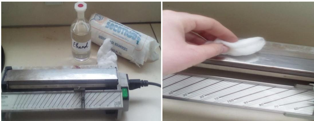
Figure III.30. Nettoyage du Banc Kofler.
