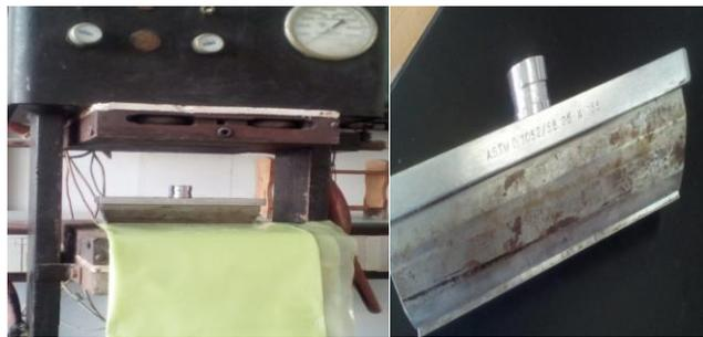
Figure III.8. La presse, la découpe des éprouvettes et l'emporte-pièce.
