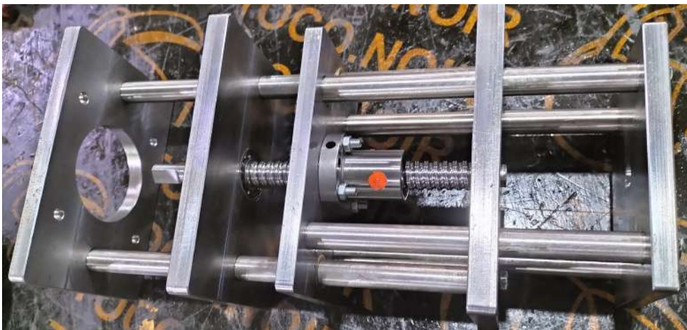
FIG. 4.12 : Montage de plaque de fixation de moteur et capteur de force
