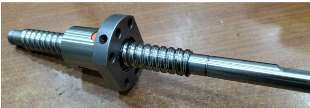
FIG. 4.8 : Montage d'écrou à billes avec vis à billes
