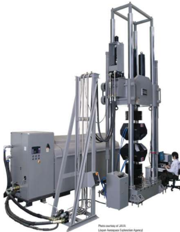
FIG. 2.2 : Machine de traction de capacité supérieure à 30MN[3]
