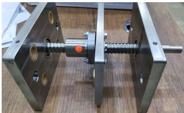
FIG. 4.10 : Montage de plaque à roulement avec vis à billes
