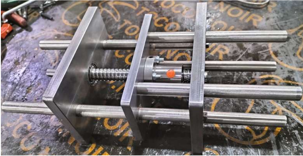
FIG. 4.11 : Montage des tiges de guidage et traction
