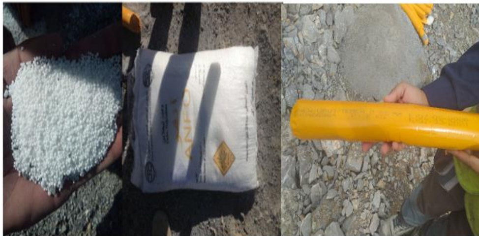
Figure V. 7. Photo de L'Anfomil et d'un cartouche de Temex (Cosider carrière).
