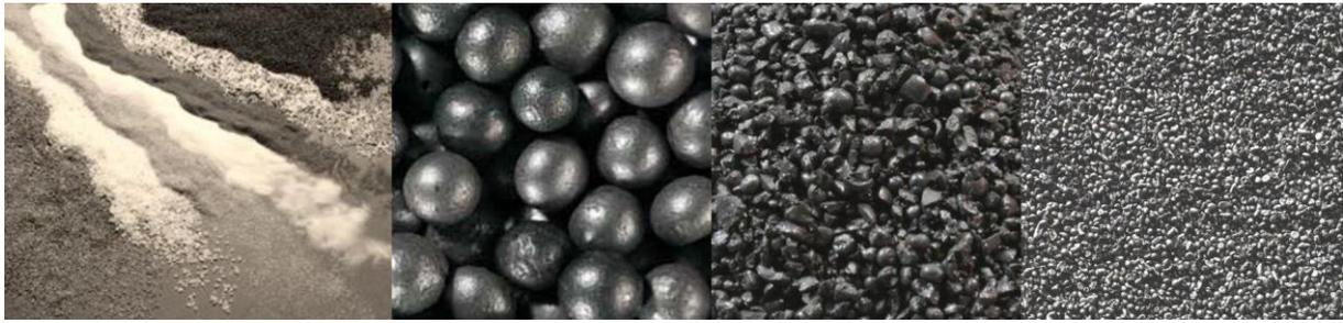
Figure 3.1 : les abrasifs ronds et angulaire utilisé dans le grenaillage [12]
