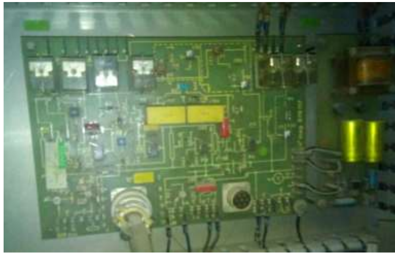
Figure 3-17 : la carte électronique des vitesses
