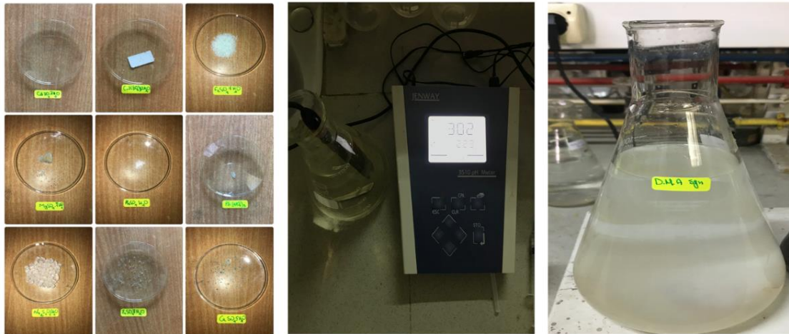
Figure 2.18 : étapes de préparation du DMA synthétique, à gauche les composants du DMA, au milieu l'ajustement du pH à 3 et à droite un litre de DMA
