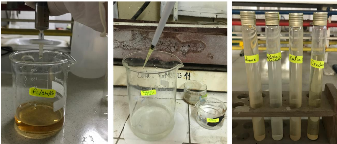
Figure 2.21 : à gauche l'opération de filtration, au milieu l'ajout de l'acide nitrique à droite la mise en tube des lixiviats
