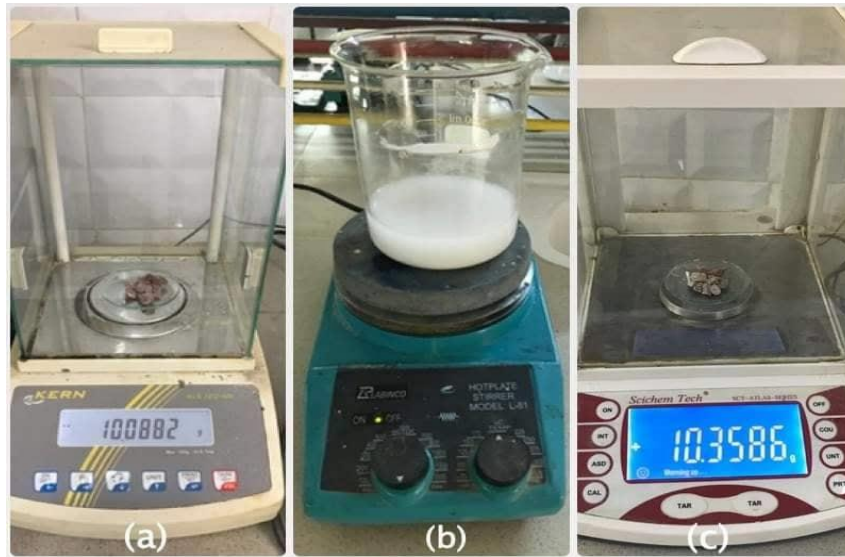
Figure 2.10: Mode opératoire de détermination de la porosité
