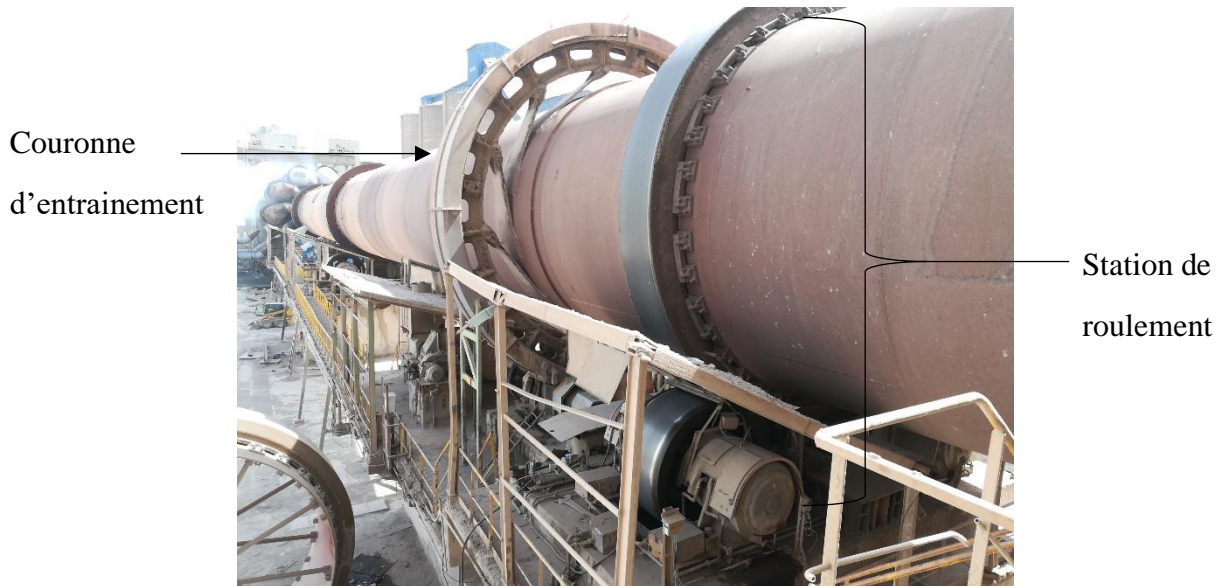
Figure 3. 3 La couronne d'entraînement et une station de roulement du four de la SCSEG
