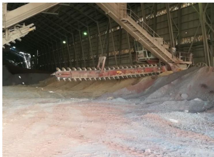
Figure 1. 8 Préhomogénéisation du sable par grateur à portique
