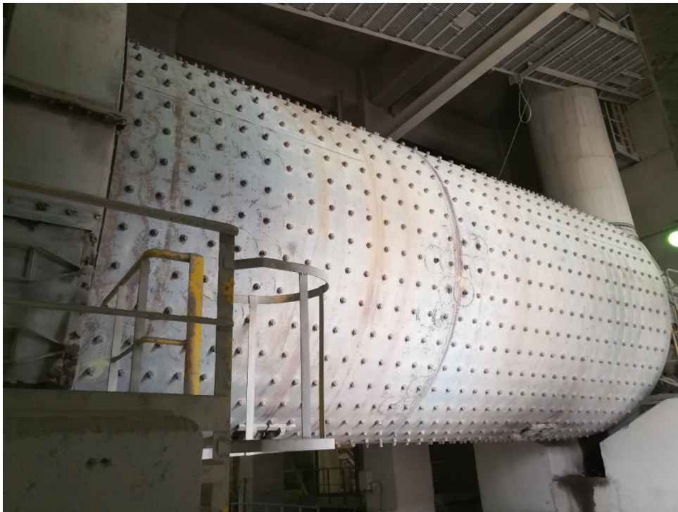
Figure 1. 9 Broyeur à boulets de l'atelier broyage cru de la SCSEG
