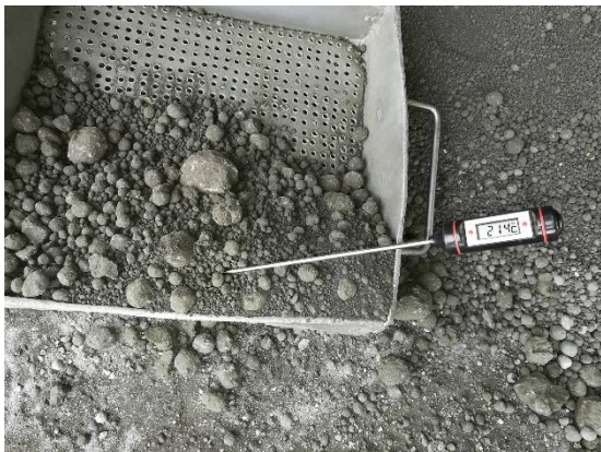
Figure 4. 3 Mesure de température du clinker
