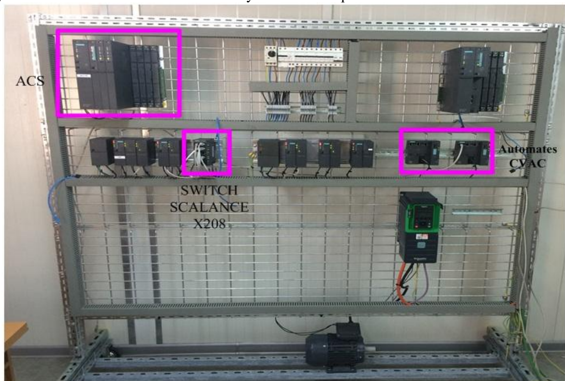
Figure 4.25 Architecture automatisme du système CVAC plateforme d'essai
