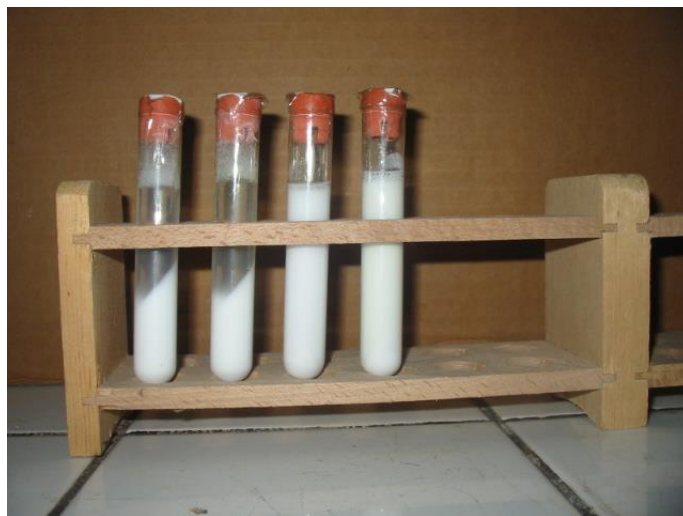
Figure 15 : Aspect des suspensions après centrifugation à 6000tours/min
