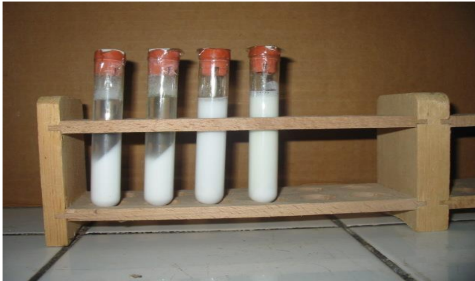
Figure 14 : Aspect des suspensions après centrifugation à 4000tours/min
