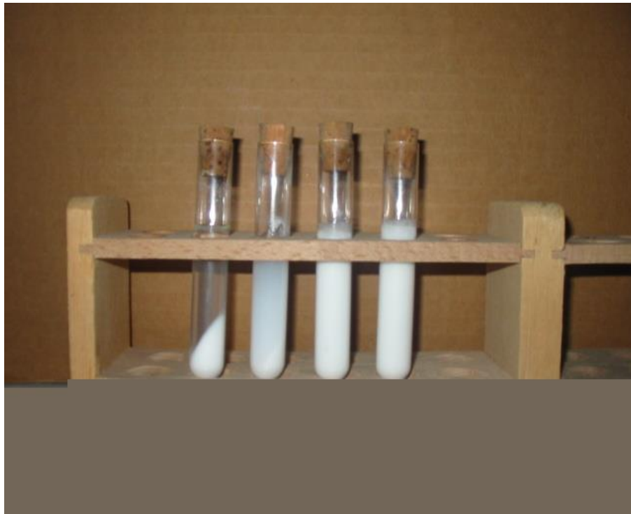
Figure 13 : Aspect des suspensions après centrifugation à 2000tours/min
