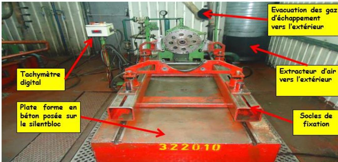
Figure 2. 2 Les composants du banc d'essais moteur de l'entreprise EMO [14].
