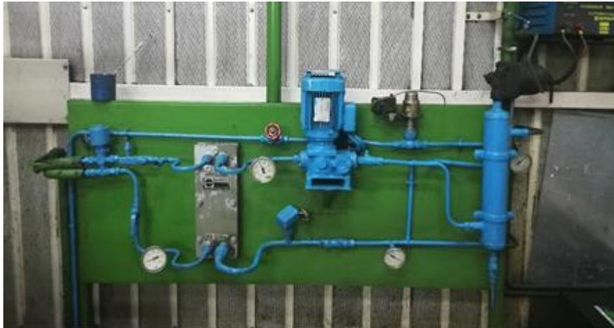
Figure 2. 7 Le système d'alimentation en gazole dans le banc d'essais.
