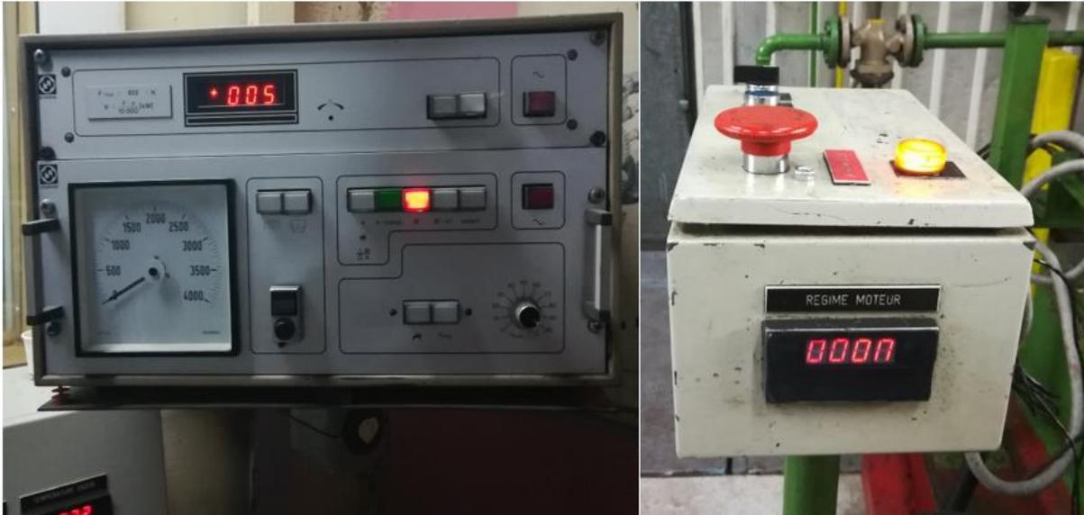
Figure 2. 8 Dispositif de rodage/réglage du moteur
