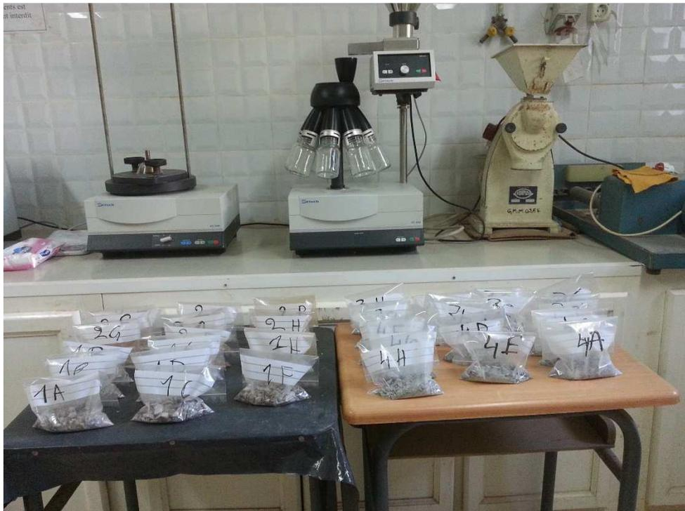
**Figure 20** : Echantillonnage à l'aide du diviseur à cône rotatif
