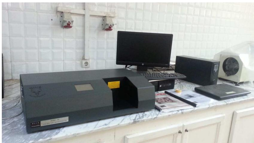
**Figure 26** : Spectroscopie infrarouge BUCK 530 du laboratoire du Génie minier
