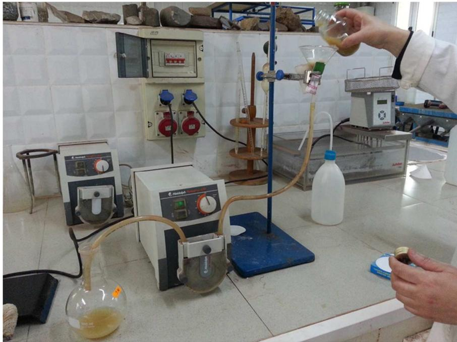
**Figure 34** : Filtration avec la pompe à vide
