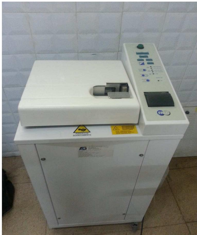
Figure 27 : Autoclave
