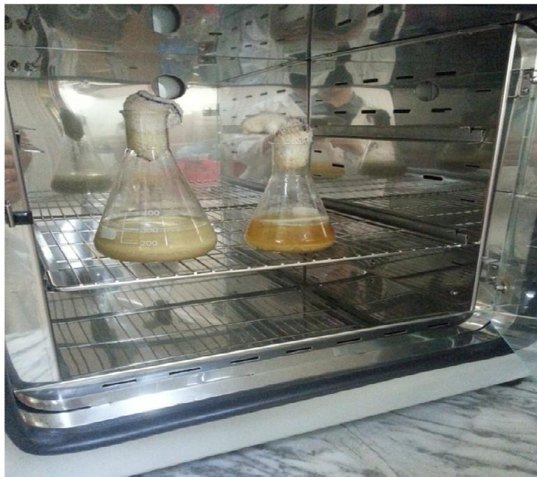
**Figure 32** : incubation des deux milieux avec les échantillons composites des minerais :A droite, milieu 9K à gauche, bouillon nutritif
