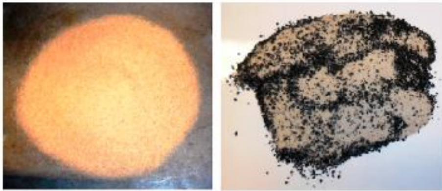
Figure 2.3 : Sable d'Hostun S28 et son mélange avec les granules de caoutchouc (préparation des échantillons, avant homogénéisation).
