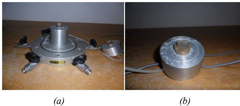
Figure 2.9: Bender elements introduits dans les embases de la cellule triaxiale, (a) embase inferieure et (b) embase superieure.
