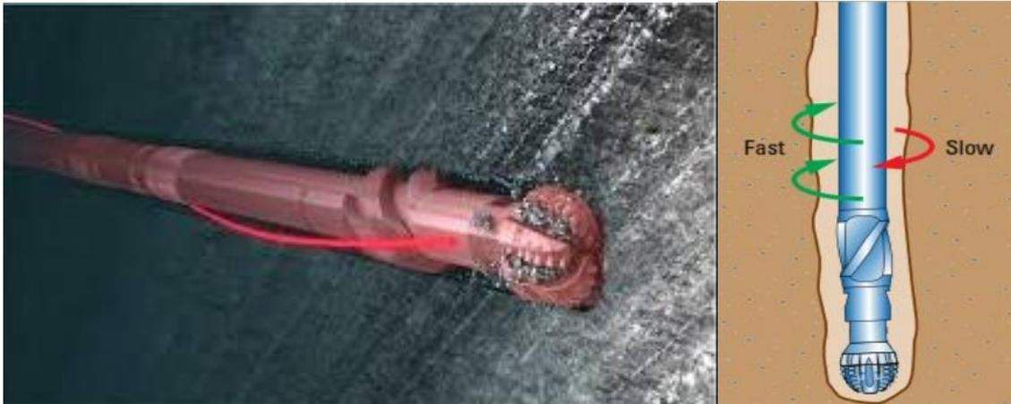
Figure 2-4 Vibration torsionnelle (*Stick-Slip*)
