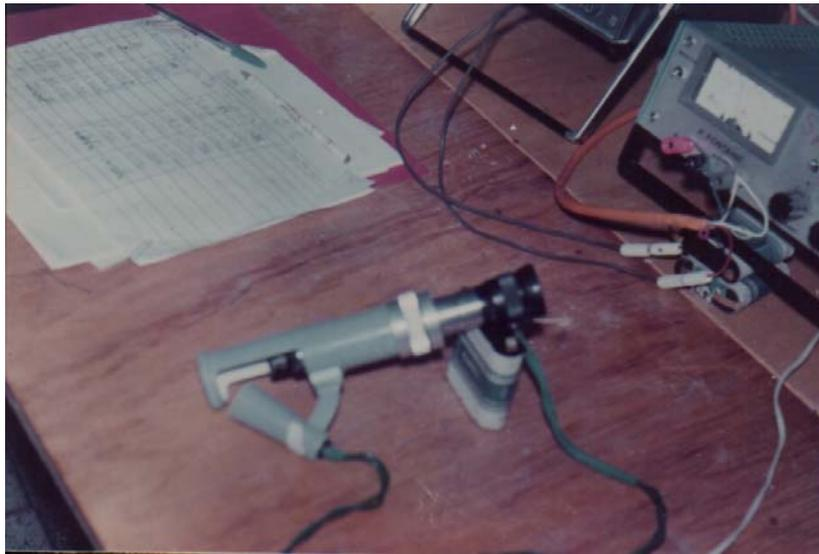
**Photo 4.12 :** Fissuromètre muni d'une loupe éclairante avec pile d'alimentation.
