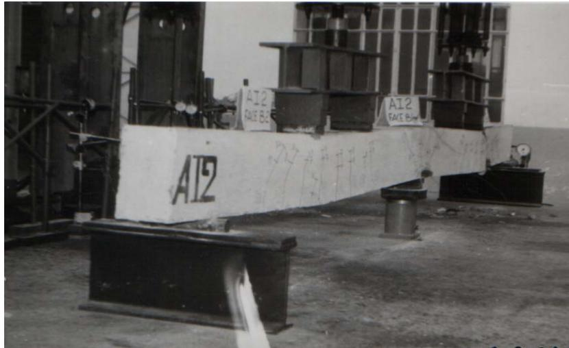
**Photo 4.8 :** Déroulement de l'essai avec positionnement des deux répartiteurs sur la poutre.
