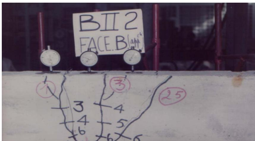
**Photo 4.13 :** Fissures relatives à différent pas de chargement.
