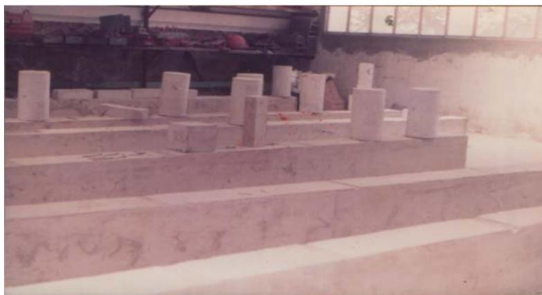
**Photo 4.4 :** *Coulage des poutres avec les éprouvettes témoins.*
