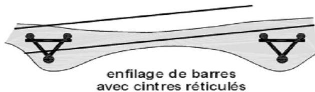
Figure II.8:Type des soutènements avec cintres par enfilage
