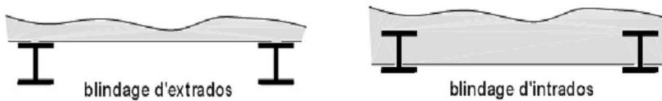
Figure II.7:Type des soutènements avec cintres par blindage
