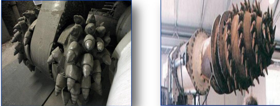
**Figure I.6:** Machine à attaque ponctuelle.[16]
