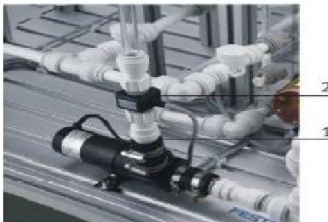
Figure I.12 Capteur fréquentiel de débit
