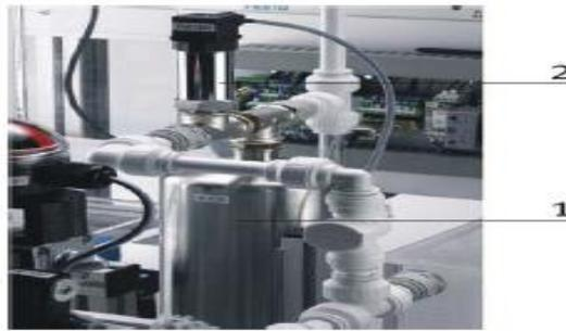
**Figure I.13 Capteur de pression**
