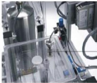
**Figure I.8 Flotteur de sécurité anti débordement**
