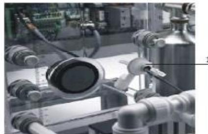
**Figure I.9 Flotteur pour la détection des seuils de remplissage**
