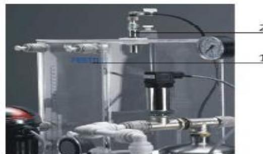
**Figure I.11 Capteur ultrasonique de niveau**
