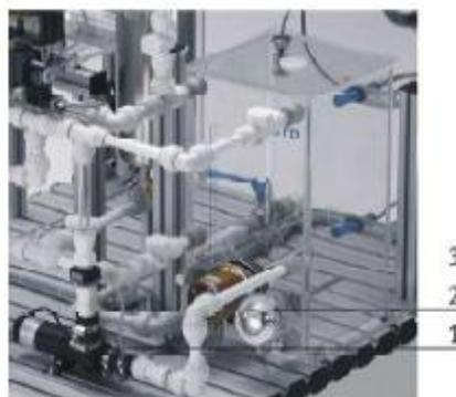
**Figure I.14 Capteur de température**
