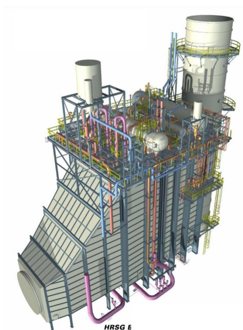
Figure 1-5 - Chaudière de récupération
