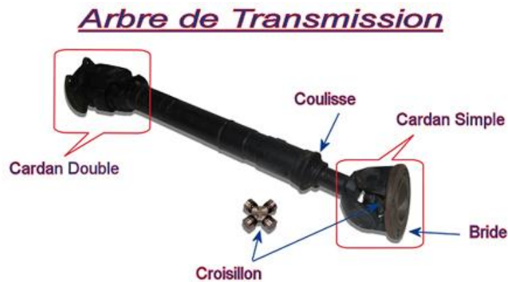
Figure 1.9 : Les composants d'un arbre de transmission
