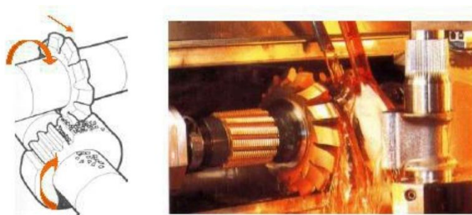
Figure 3.1 : Taillage à la fraise disque
