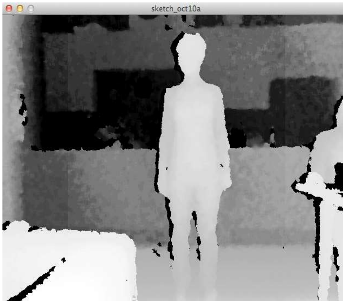
Fig. C.3 Image de profondeur perçue par la Kinect
