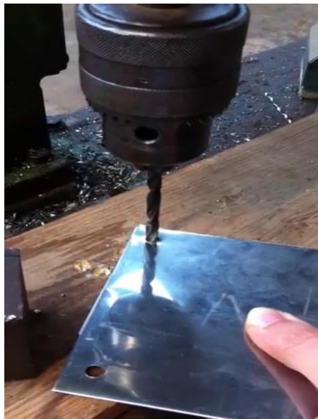
Figure III.8: Photo de perçage des plaques.
