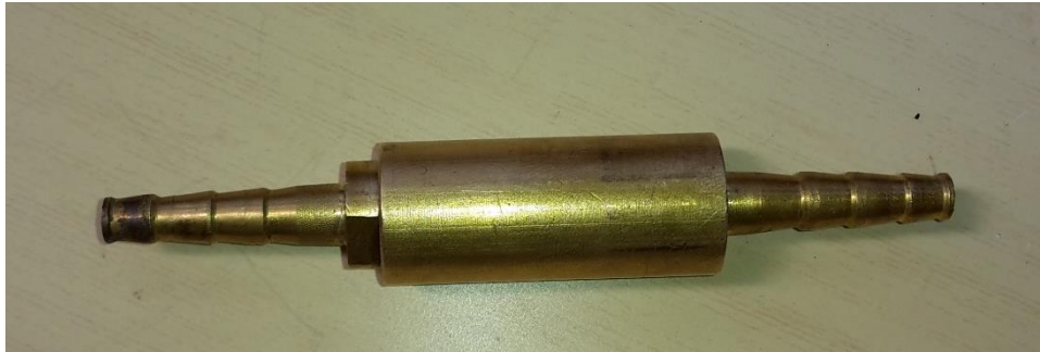
Figure III.18: Photo du clapet anti-retour de flamme.
