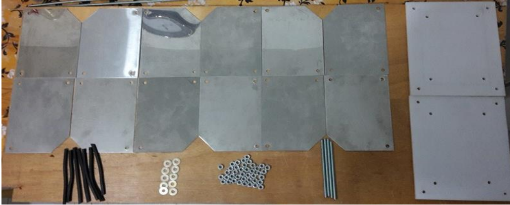
Figure III.7: Photo montrant les plaques d'une cellule démontée.
