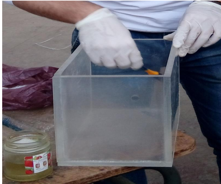
Figure III.13: Photo montrant l'application du chloroforme à la cellule.
