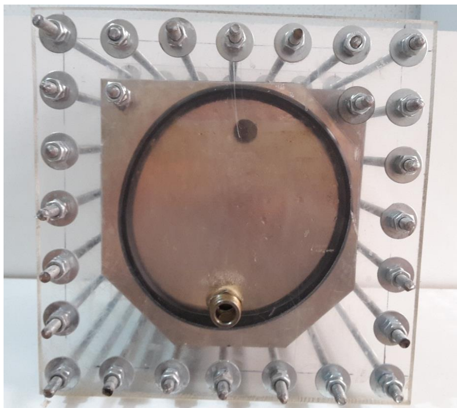
Figure III.22: Photo de la face avant de la dry cell (entrée d'eau).
