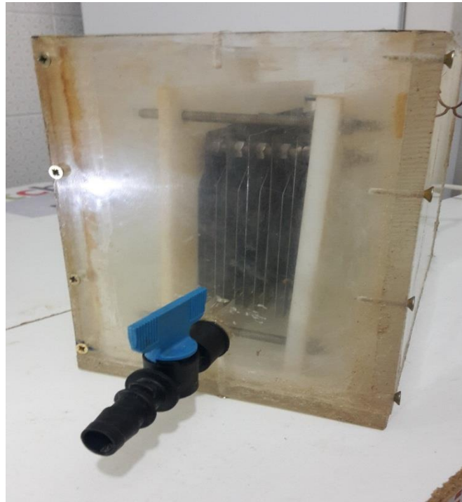
Figure III.15: Photo montrant le robinet de remplissage et de vidange.
