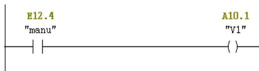
Figure V.13. Exemple sur les bobines de sorties
