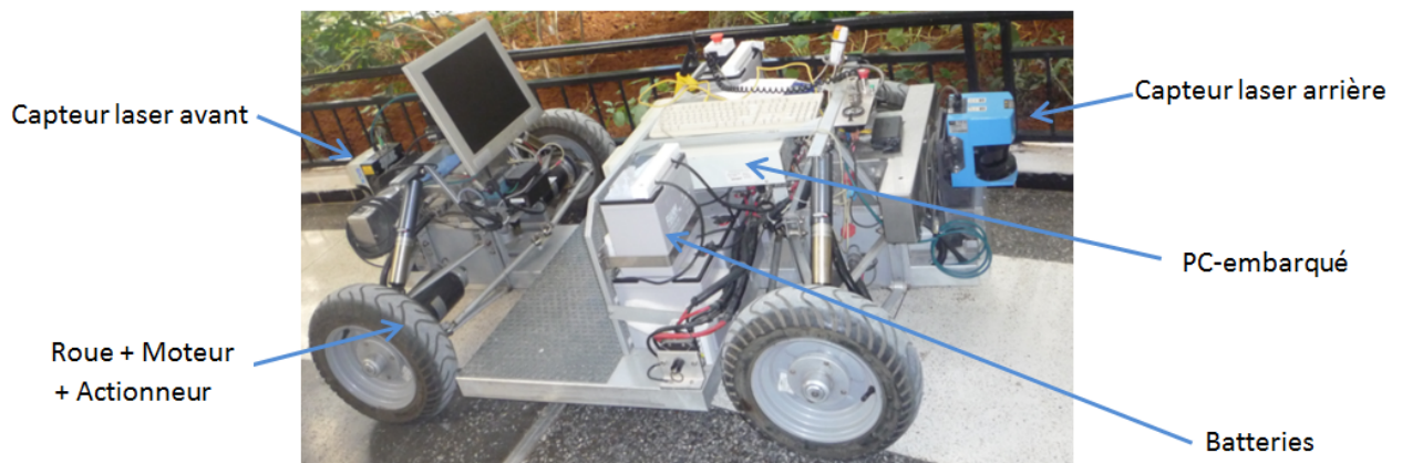
FIGURE 3.1 – Principaux constituants matériels du Robucar
