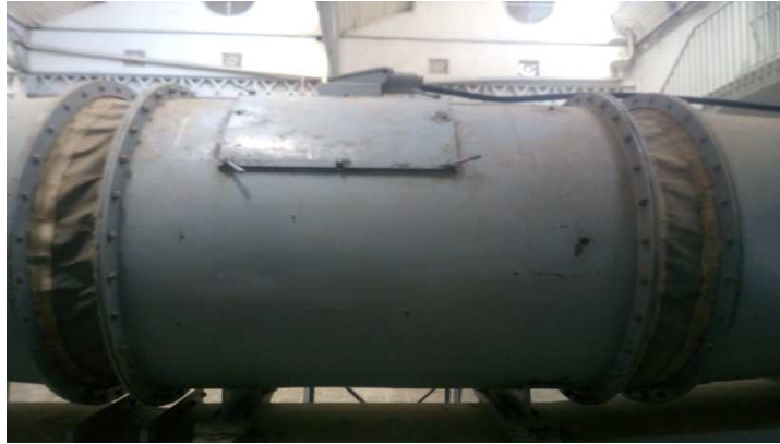
Figure 2.5 : La partie cylindrique contenant le moteur
