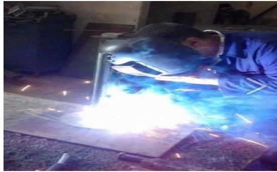
Figure 3.12 : Le soudage du tube avec le disque
