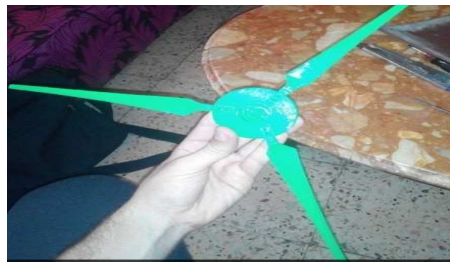
Figure 3.10 : L'assemblage des pales avec le nez.
