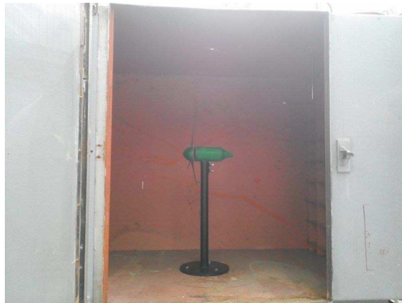
Figure4.4 : La veine d'essais de la soufflerie.
