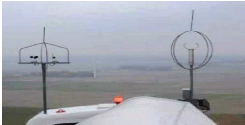
Figure 1.15 : Anémométrie à la nacelle [18]
