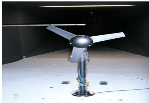
Figure 2.11 : L'éolienne testée dans la veine d'essai
