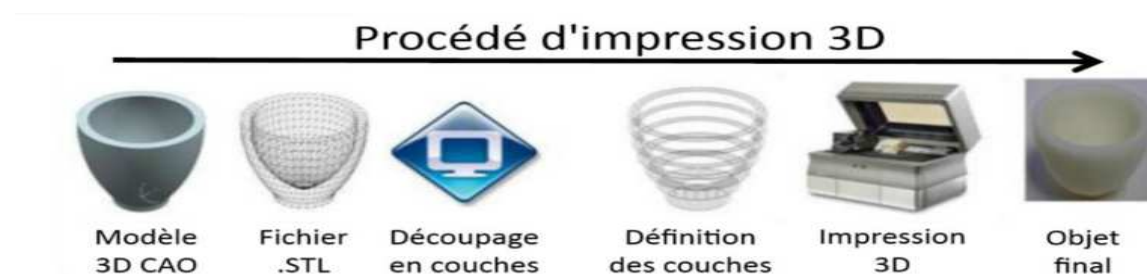
Figure 3.4 :Le procédé d'impression 3D en quelques étapes simplifiées.
