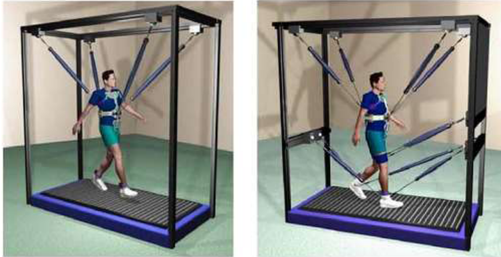
FIGURE 1.5 – Le prototype mécanique de STRING-MAN [6]
