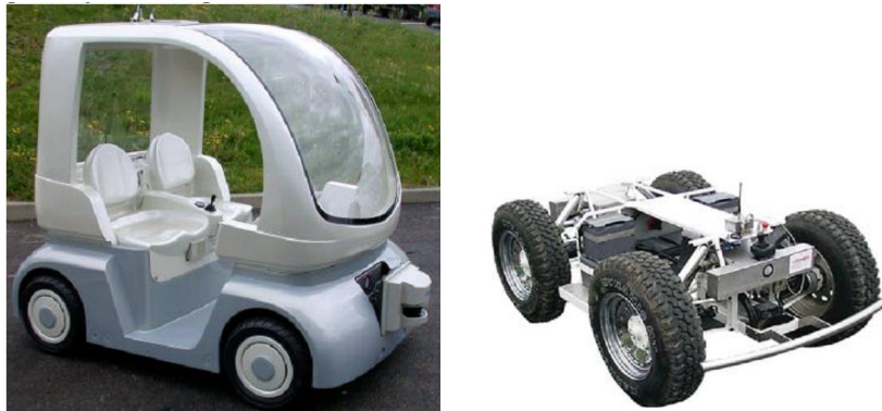
Figure 4.4 : A gauche : Le CyCab. A droite : Un Robucar TT : déclinaison tout terrain du Robucar
