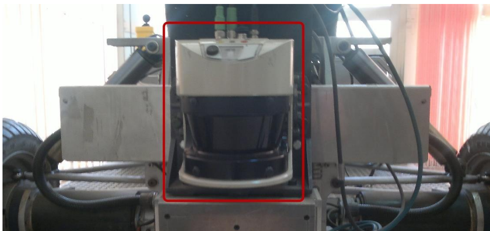
Figure 4.9 : Le capteur laser SICK LMS 511 monté sur l'avant du Robucar
