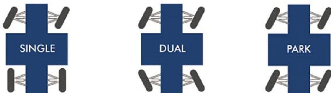
Figure 4.6 : Les trois modes de braquage du Robucar
