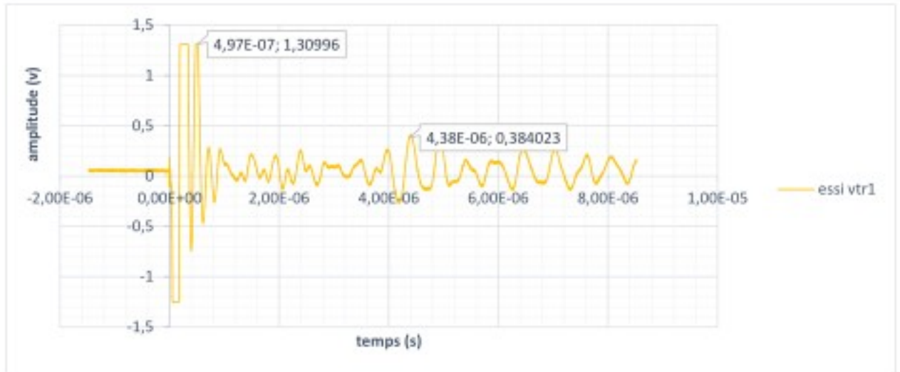
Figure IV. 12 : Signal temporel des échos enveloppées de l'onde transversale en immersion du verre /époxy
