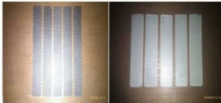
Figure II. 14 :à droite éprouvette en tissu de verre ;à gauche en fibre de carbone.
