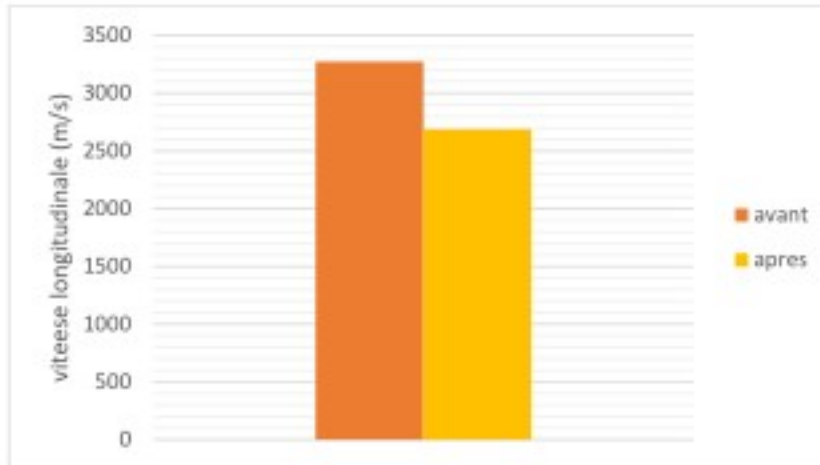
Figure IV. 11 : comparaison vitesse longitudinale avant et après l'endommagement époxy/verre.
