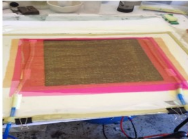
Figure II. 13 : Remplacement complet du vide par la résine.
