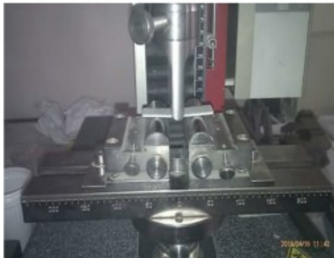
Figure III. 12 : essai de flexion EPOCAST50 A1/tissu en fibre de verre.
