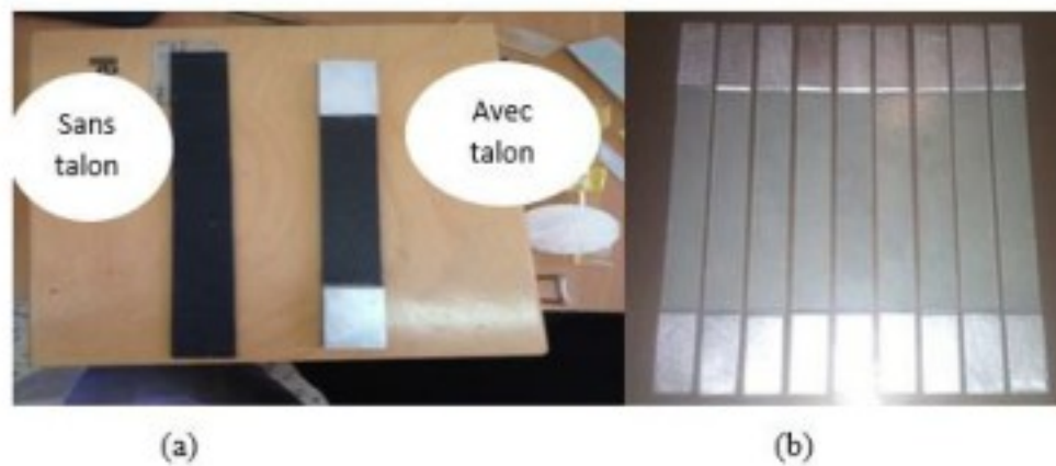
Figure III. 2 : (a)Eprouvette en fibres de carbone, (b) Eprouvette en fibres de verre selon la norme ASTM D3039
