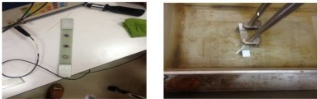
Figure IV. 6 : Contrôle ultrasonore par immersion d'éprouvette de composite stratifié en tissu de verre
