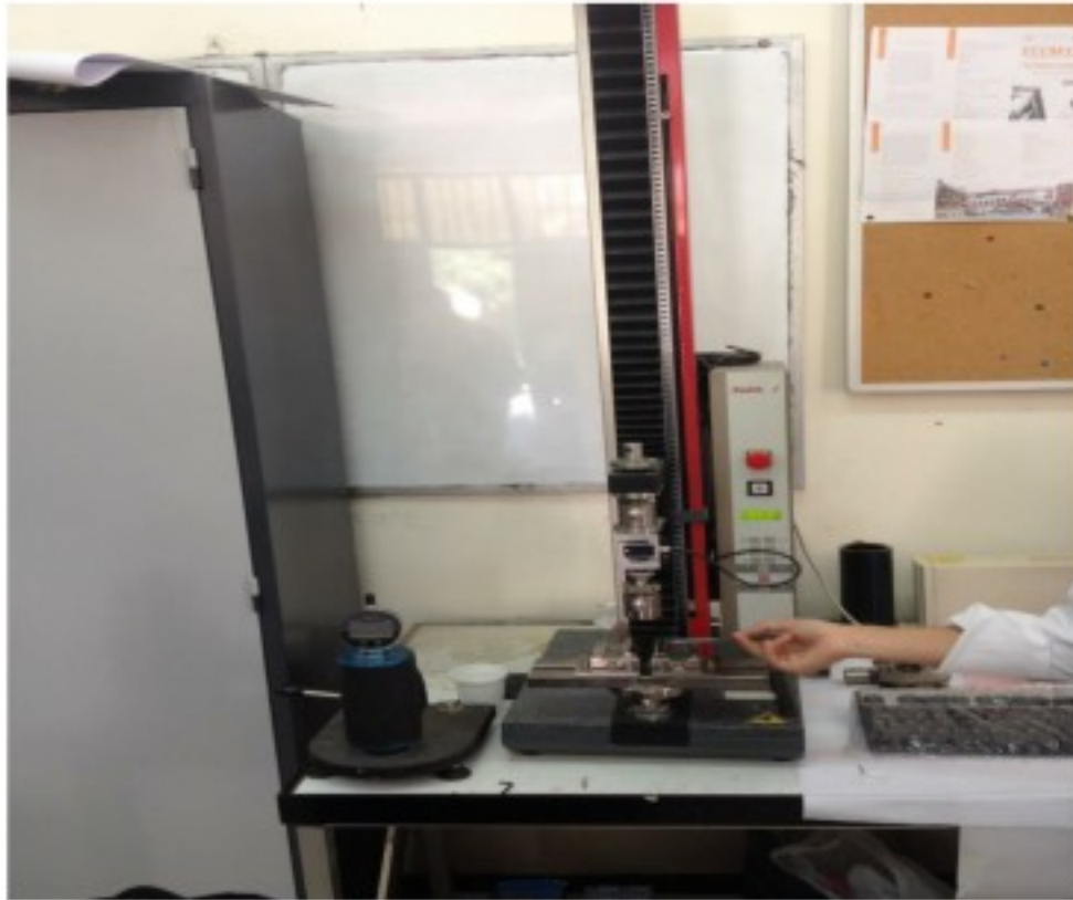
Figure III. 11 : Une machine pour les essais de flexion de type Zwick 2.5 kN
