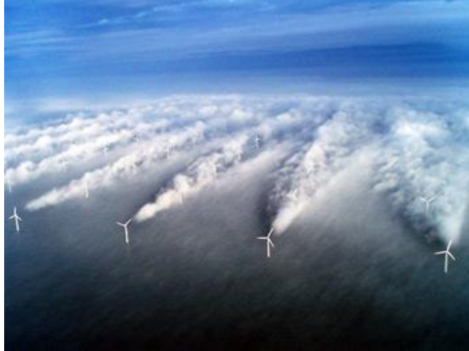
Figure 2.4 Rotation du sillage des éoliennes [23].
