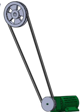
Figure II.9: chaîne de transmission de puissance
