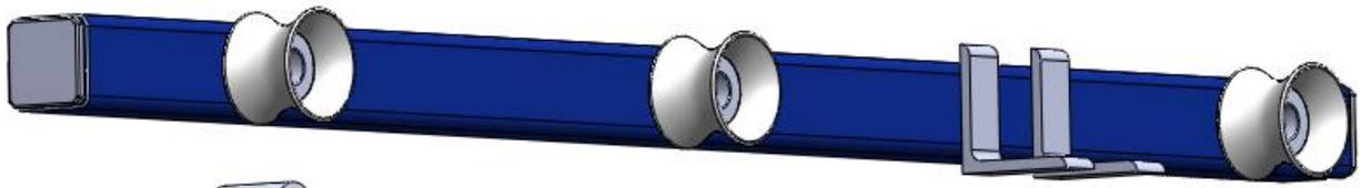
Figure II.11: barre avec galets de guidage de la gaine
