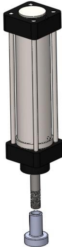
Figure II.14: vérin d'entraînement de la cisaille
