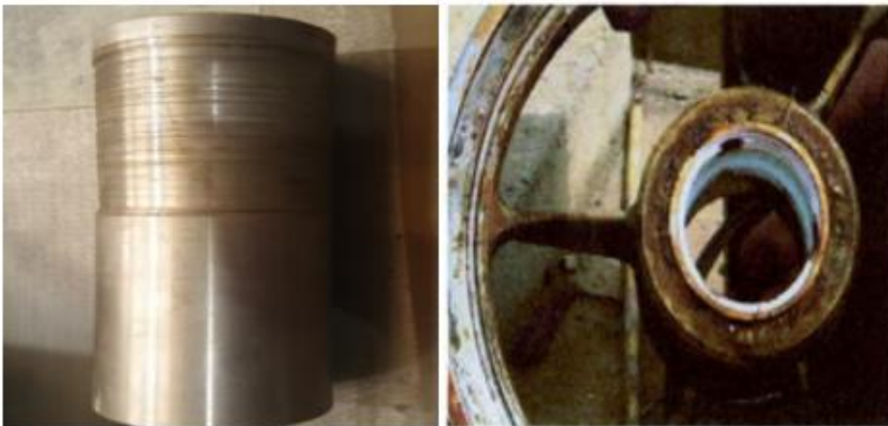
Figure 2.5 : L'usure des chemises et des coussinets Après le démontage de la pompe
