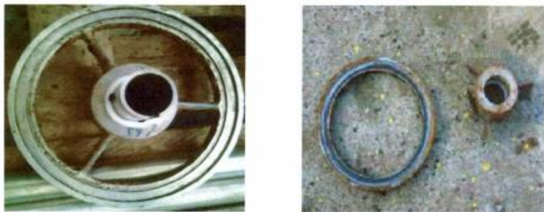
Figure 2.7: Rupture des Logements des paliers
